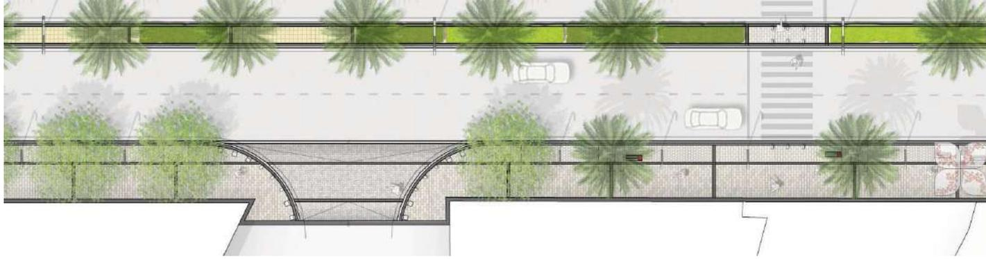
الشكل ١٧/٢ ملخص نموذج تصميم يبين الأشجار المتساقطة بطول طريق المشاة، وأشجار النخيل التي تظل مناطق الجلوس ومعايير المشاة وهيكل التظليل المقرب المصمم خصيصاً للمشروع
